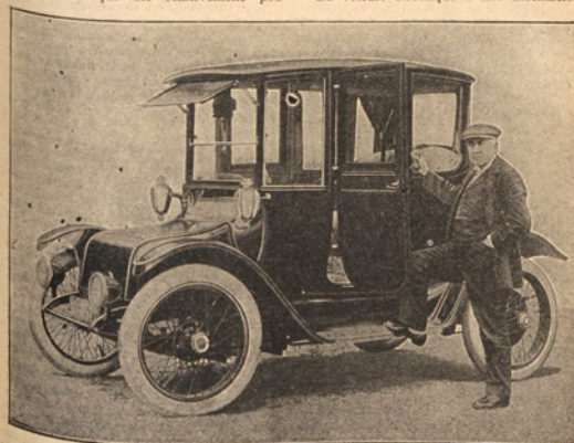
LA VOITURE ÉLECTRIQUE DE L'ILLUSTRE INVENTEUR AMÉRICAIN THOMAS EDISON Cette voiture, construite dans les ateliers de l'Anderson Electric Car Company, à Detroit, a un rayon d'action de 55 à 120 kilomètres. Sa vitesse est de 35 kilomètres à l'heure, ce qui est suffisant pour son usage spécial ; son poids total est, en ordre de marche, de 1.700 kilogrammes.
